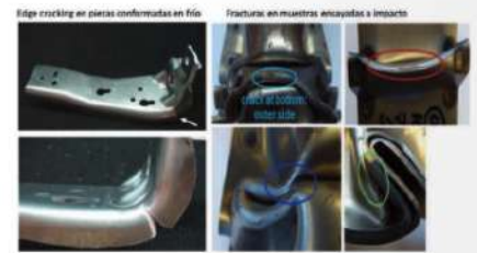
FIGURA 1. Ejemplos de fracturas relacionadas con el agrietamiento en chapas de aluminio de alta resistencia.
